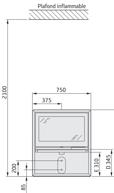
La distance minimale devant l'ouverture du poêle à un élément de construction ou d'ameublement inflammable doit être de 1,4 mètre.
