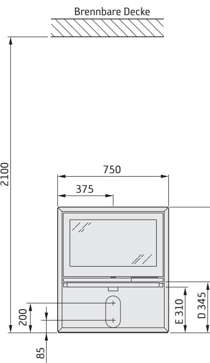
Der Mindestabstand zwischen Kaminofenöffnung und einem brennbaren Gebäudeteil oder Einrichtungsgegenständen beträgt 1,4 m.
