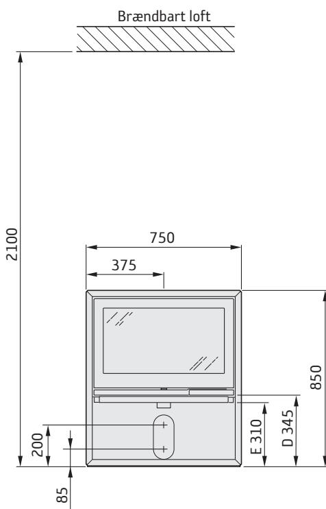
Der skal være mindst 1,4 meter foran brændeovnens åbning til brændbare bygningsdele eller indbo.
