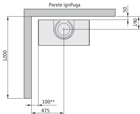
\* Se la stufa è collocata su una piastra di protezione per il pavimento ad esempio in vetro (optional), la distanza dal pavimento va modificata del corrispondente spessore della piastra di protezione, nel caso del vetro di 10 mm.
