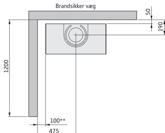
\* Hvis brændeovnen placeres på en gulvplade af f.eks. glas (ekstraudstyr), påvirkes højden fra gulvet med et mål svarende til gulvpladens tykkelse. For fritliggende gulvplade i glas er dette mål 10 mm.
