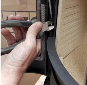
Enlevez la goupille et serrez la vis (dans le sens de l'aiguille d'une montre) en fonction de la vitesse de fermeture souhaitée. Remettez la goupille.
